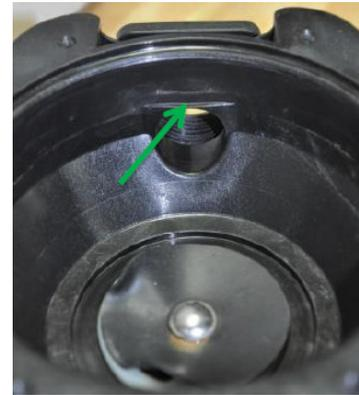
**THE FLAT PORTION OF THE CARTRIDGE MUST ALIGN WITH THE FLAT ABOVE THE DISCHARGE PORT.**
