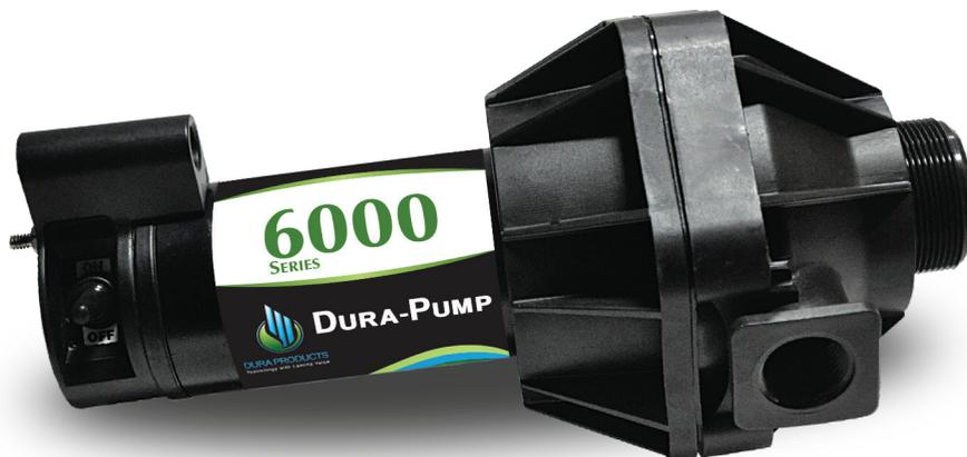
A Bomba de Transferência DURA-PUMP™ 6000 Series (DP-6000) é uma bomba de diafragma autoeskorvante, de deslocamento positivo, com alimentação de 12 volts DC ou 110 volts AC, não classificada pela UL. Ela foi projetada para transferência e recirculação de fluidos não inflamáveis. A bomba inclui um cabo de alimentação de 6 metros (20 pés) com garras jacaré e um fusível em linha. Apresenta uma entrada NPT de 1 polegada e uma porta de descarga NPT de 1 polegada.
