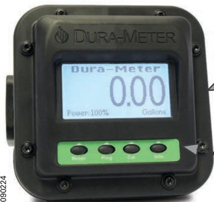
O medidor liga ao pressionar qualquer botão ou quando há passagem de fluido. Desliga-se automaticamente quando não está em uso.
