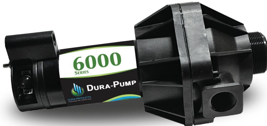
La bomba de transferencia DURA-PUMP™ serie 6000 (DP-6000) es una bomba de diafragma autocebante, de desplazamiento positivo, alimentada por 12 voltios CC o 110 voltios CA, que no está listada por UL. Fue diseñado para la transferencia y recirculación de fluidos no inflamables. La bomba incluye un cable de alimentación de 6 metros (20 pies) con pinzas de cocodrilo y un fusible en línea. Cuenta con una entrada NPT de 1 pulgada y un puerto de descarga NPT de 1 pulgada.
