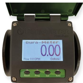
O Dura Auto-Batch High-Flow Meter é um dispositivo automatizado para transferência de fluidos. Basta inserir a quantidade desejada, ligar a bomba e pressionar Start. O medidor abre uma válvula para liberar o fluido e a fecha quando a quantidade programada é alcançada. O sistema requer o kit de válvula de alívio ajustado especialmente pela Dura para funcionar corretamente. Pode ser encomendado como um kit completo, incluindo o medidor, a válvula e a válvula de alívio.
