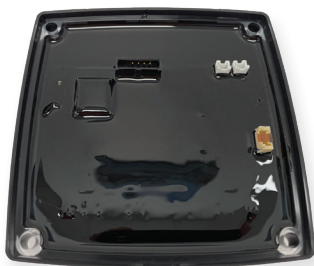
Circuito selado contra umidade.
