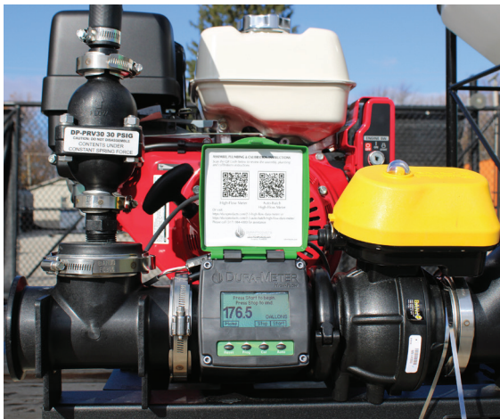
Sistema de dosagem e medição de alta vazão Auto-Batch™
