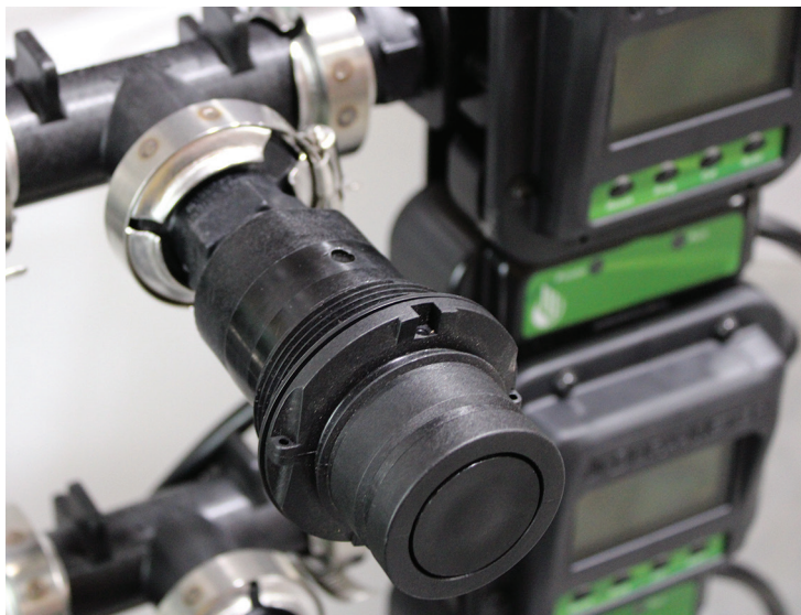
Conexões para calibração tipo Dry Poppet
