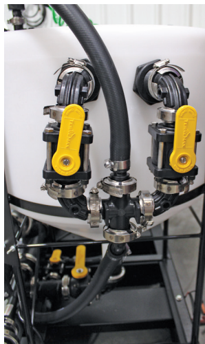
Cone de 150 litros com lamina de corte de embalagens e enxágue
